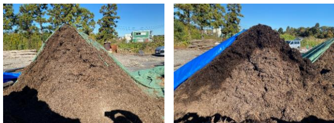
図1 Toptex とブルーシートをかけたチップの比較
